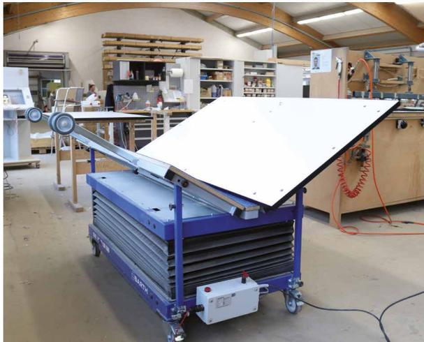
Der höhenverstellbare Arbeitstisch mit Wendeeinrichtung für schwere Werkstücke.
